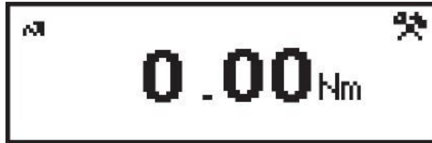
Peak 模式可以记录拧紧时扭矩的峰值同时我们也可以看到螺栓所旋转的角度。在此模式下我们可以通过屏幕右上角的设置图标进行目标扭矩及上下限的设置，以及对扭矩门槛和角度的设置。
