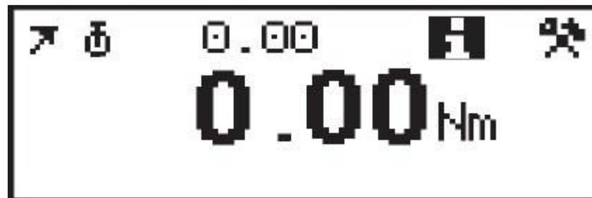
Audit Control 模式不仅可以通过扭矩进行控制，也可以通过角度控制。我们可以测试螺栓的软硬程度，通过角度来进行控制。这样就可以对软硬程度不同的螺栓进行精确的更测试。
